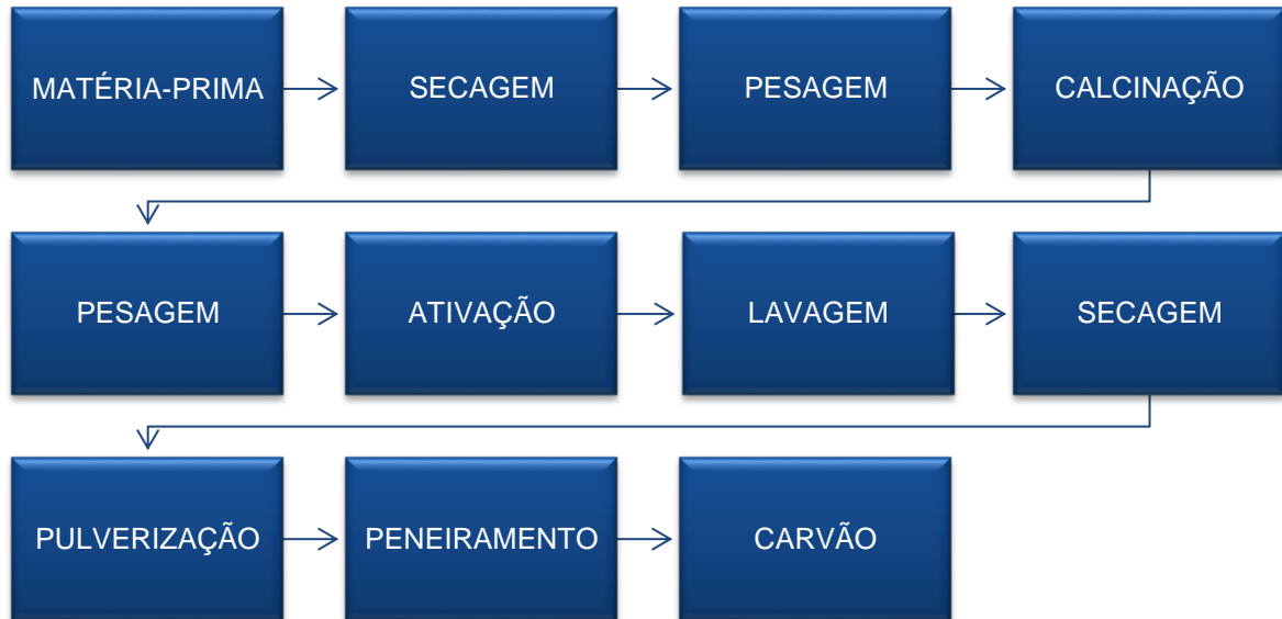
Figura 7 Fluxograma do processo de Produção do carvão ativado
