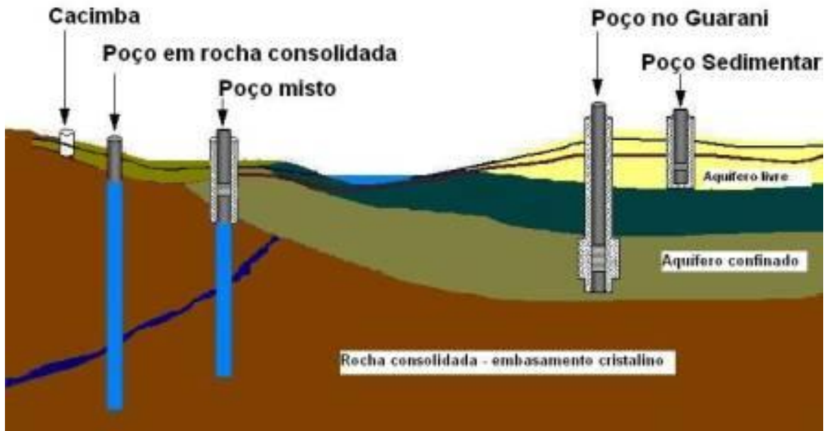
Figura 2: Esquema representativo dos tipos de poços exigentes.
