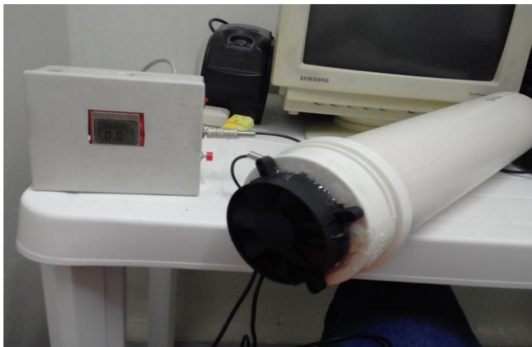
Figura 3: Miniestação meteorológica portátil com arduino.
