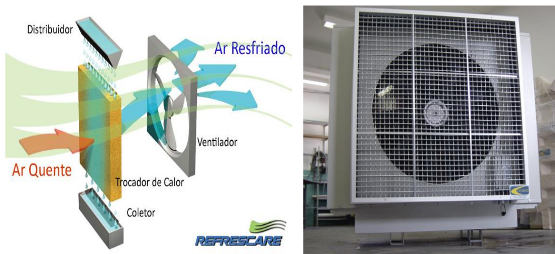
Figura 11: Exemplo climatizador e umidificador
