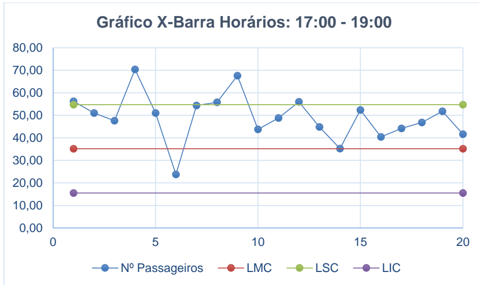
Gráfico 14 - Médias de passageiros por ônibus nos horários de 17:00 às 19:00, simulação com 1 ônibus
