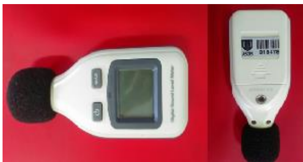
Figura 1: Decibelímetro utilizado para medição de ruídos no perímetro da feira da sulanca.
