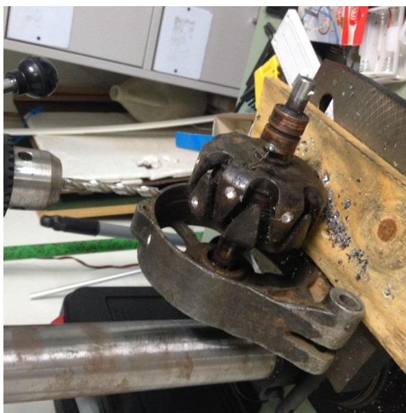
Figura 5. Carcaça de um alternador de carro sendo adaptado para geração de energia eólica.
