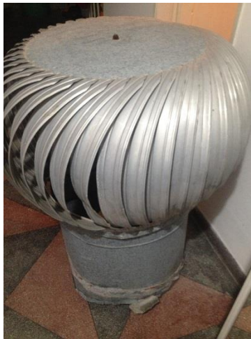
Figura 7. Exaustor utilizado como Hélice de um aero gerador
