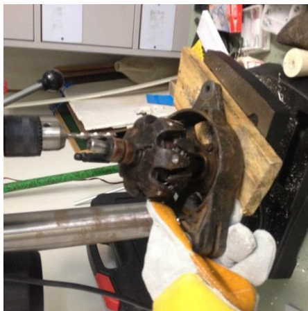
Figura 6. Carcaça de um alternador de carro adaptado para geração de energia eólica com acoplamento de ímãs de neodímio
