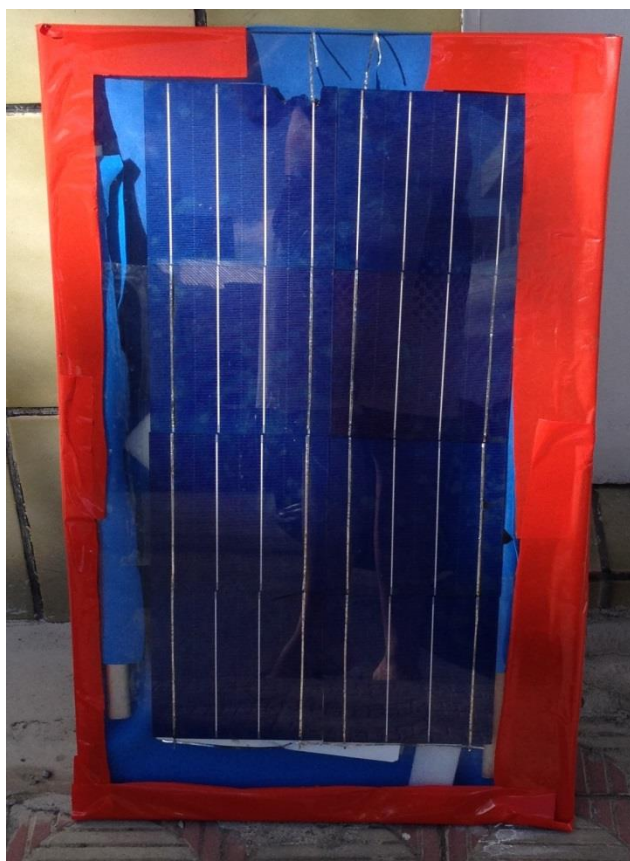
Figura 8. Painel montado através de células individuais de forma a reduzir gastos
