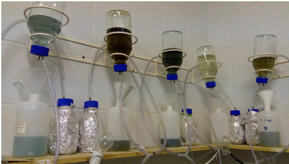
Figura 2. Esquema utilizado na realização do teste AME
