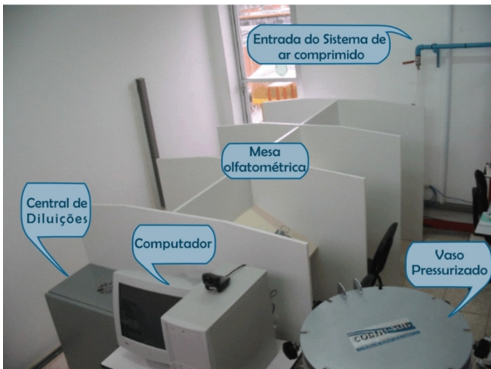
Figura 9 - Componentes do sistema do olfatômetro ODILE 2000
