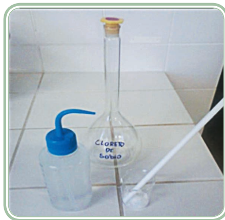
Figura 3.15: (a) Diluir a solução com um pouco de água no béquer; (b) mexer com auxílio da vareta e colocar no balão.
