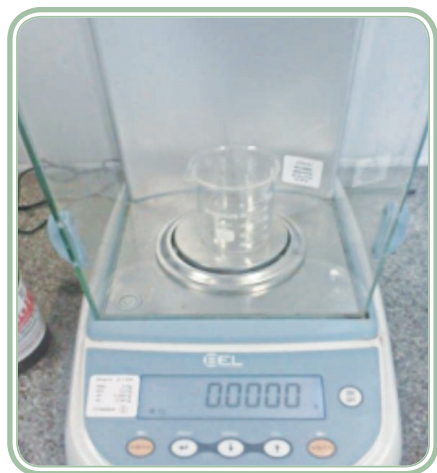
Figura 3.13: Pesar os solutos separados em bquer em balança analítica.
