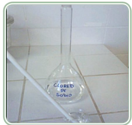
Figura 3.15: (a) Diluir a solução com um pouco de água no béquer; (b) mexer com auxílio da vareta e colocar no balão.
