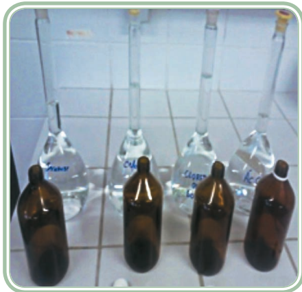
Figura 3.17: Transferir a solução do balão para o frasco âmbar.
