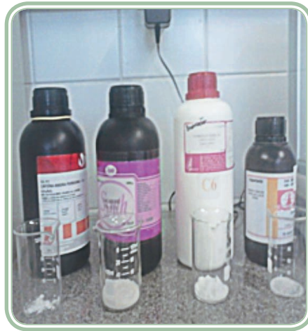
Figura 3.14: Materiais pesados e separados para diluição.
