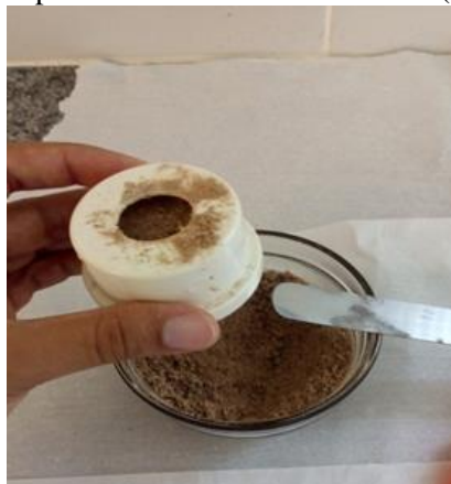
Figura 10. Preenchendo a vela adaptada com material adsorvente (SEMENTE DE UMBU).
