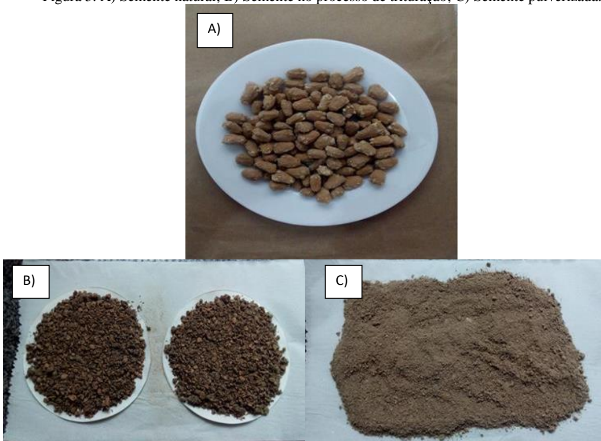
Figura 5. A) Semente natural; B) Semente no processo de trituração; C) Semente pulverizada.
