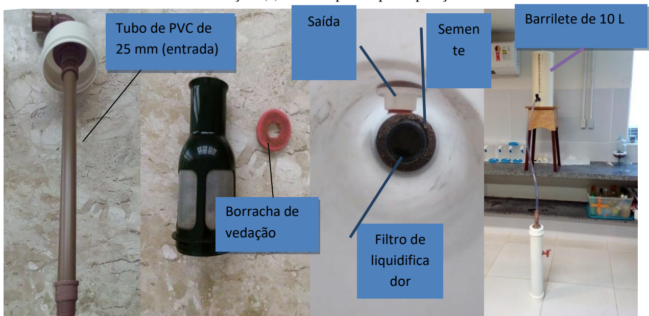
Figura 12. Materiais utilizados na confecção do Reator II. (a) Cap PVC de 100 mm com adaptação para um cano de 25 de mm por onde a água entra no sistema; (b) Peças usadas para vedação da entrada de água e sustentação do material adsorvente; (c) Interior do reator já com o material adsorvente e o suporte de sustentação. (d) reator II pronto para operação.
